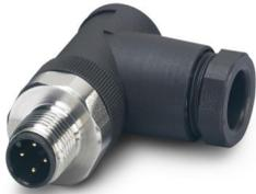
Connettore, Universale, 4-poli, Maschio angolato M12, codifica: A, Connessione a vite, materiale zigrinato: Acciaio legato 1.4404, connessione a vite per cavo Pg9, diametro esterno conduttore 6 mm ... 8 mm
