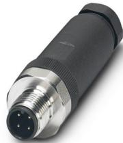
Connettore, Universale, 4-poli, Maschio diritto M12, codifica: A, Connessione a vite, materiale zigrinato: Acciaio legato 1.4404, connessione a vite per cavo Pg9, diametro esterno conduttore 6 mm ... 8 mm
