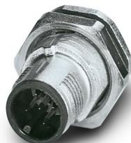
Connettore per apparecchi posteriore, 5-poli, Connettore, diritto, M12-SPEEDCON, codifica: A, Montaggio posteriore, Pg9, Codoli, Prodotto alternativo secondo RoHS II senza eccezione 6c (Pb < 0,1 %) cod. art.: 1240027
