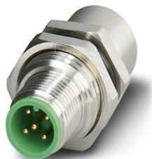
Passaggio sensore/attuatore per quadri elettrici, maschio su femmina, 5 poli, M12, schermato, codifica A, montaggio bipolare/a vite con filettatura M16
