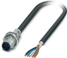
Connettore per apparecchi posteriore, 5-poli, PUR, grigio-nero RAL 7021, Connettore, diritto, codifica: A, su estremità conduttore libera, Montaggio posteriore, filettatura M16 x 1,5 con dado piatto, M16 x 1,5, Attacco capocorda, lunghezza cavo: 0,5 m, PUR senza alogenati nero, Questo articolo è in continuo adattamento. Alternativa senza piombo secondo RoHS II senza eccezione 6c (Pb < 0,1%) possibile in anticipo su richiesta.
