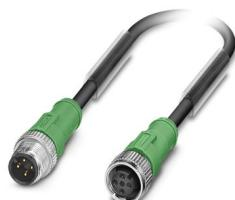
Cavo sensore/attuatore, 4-poli, PUR senza alogenati, reticolato, resistente ai residui di saldatura, arancio RAL 2003, Maschio diritto M12, codifica: A, su Connnettore femmina diritto M12, codifica: A, lunghezza cavo: 2 m
