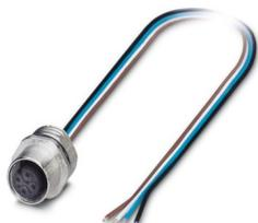
Connettore per apparecchi anteriore, 4-poli, Femmina, diritto, M12, codifica: A, su estremità conduttore libera, Montaggio anteriore, M16 x 1,5, Fili singoli, lunghezza cavo: 3 m, 0,34 mm<sup>2</sup>, Filo in TPE, saldato
