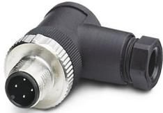
Connettore, Universale, 4-poli, Maschio angolato M12 SPEEDCON, codifica: A, Connessione a vite, materiale zigrinato: Ottone, nichelato, connessione a vite per cavo Pg7, diametro esterno conduttore 4 mm ... 6 mm
