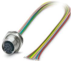
Connettore per apparecchi posteriore, Universale, 8-poli, Femmina, diritto, M12-SPEEDCON, codifica: A, su estremità conduttore libera, Montaggio posteriore, Pg9, Fili singoli, lunghezza cavo: 0,5 m, 0,25 mm<sup>2</sup>, Filo in TPE, saldato, Prodotto alternativo secondo RoHS II senza eccezione 6c (Pb < 0,1 %) cod. art.: 1239959
