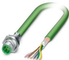
Connettore per apparecchi posteriore, INTERBUS (16 MBit/s), 5-poli, PUR senza alogenati, verde RAL 6017, schermata, Connnettore, diritto, M12-SPEEDCON, codifica: B, su estremità conduttore libera, Montaggio posteriore, M16 x 1,5, Collegamento del cavo, lunghezza cavo: 0,5 m, INTERBUS, Questo articolo è in continuo adattamento. Alternativa senza piombo secondo RoHS II senza eccezione 6c ( $Pb < 0,1\%$ ) possibile in anticipo su richiesta.
