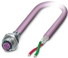
Connettore per apparecchi posteriore, PROFIBUS, 2-poli senza alogenati, lilla rossastro RAL 4001, schermata, Femmina, diritto, M12, codifica: B, su estremità conduttore libera, Montaggio posteriore, M16 x 1,5, Collegamento del cavo, lunghezza cavo: 5 m, PROFIBUS, Prodotto alternativo secondo RoHS II senza eccezione 6c (Pb < 0,1 %) cod. art.: 1239931
