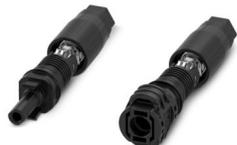
Connettore per circuiti stampati per impianti fotovoltaici, famiglia di prodotti: XLIX, connettore, materiale della custodia: PC/PA; colore: nero; numero di poli: 1; sezione minima del conduttore: 4 mm<sup>2</sup>; corrente nominale: 35 A; sezione massima del conduttore: 6 mm<sup>2</sup>; corrente nominale: 40 A; tipo di connessione: molla; tipo di commutazione del contatto: connettore femmina
