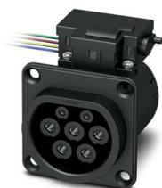
CHARX connect modular, Tipo 2, Presa di ricarica lato infrastruttura, 32 A , 480 V AC, Basic, senza fili singoli, attuatore di bloccaggio: 12 V, 4 poli, squadrato, Montaggio sulla parete posteriore, Filettatura M5, custodia: nero, per la ricarica con corrente alternata (AC) di veicoli elettrici (EV), Logo PHOENIX CONTACT, IEC 62196-2
