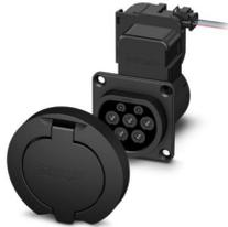
CHARX connect modular, Tipo 2, Presa di ricarica lato infrastruttura, 32 A , 480 V AC, Basic, Set, senza fili singoli, attuatore di bloccaggio: 12 V, 3 poli, squadrato, Montaggio sulla parete posteriore, Filettatura M5, custodia: nero, con coperchio di protezione rotondo, per la ricarica con corrente alternata (AC) di veicoli elettrici (EV), Logo PHOENIX CONTACT, IEC 62196-2
