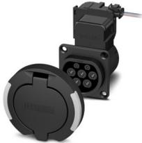
CHARX connect modular, Tipo 2, Presa di ricarica lato infrastruttura, 32 A , 480 V AC, Basic, Set, senza fili singoli, attuatore di bloccaggio: 12 V, 3 poli, squadrato, Montaggio sulla parete posteriore, Filettatura M5, custodia: nero, con coperchio di protezione rotondo, con LED (collegamento catodo in comune), per la ricarica con corrente alternata (AC) di veicoli elettrici (EV), Logo PHOENIX CONTACT, IEC 62196-2
