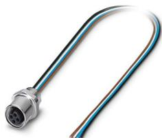
Connettore per apparecchi anteriore, 4-poli, Femmina, diritto, M5, codifica: A, Montaggio anteriore, M5 x 0,5, Fili singoli, lunghezza cavo: 0,5 m, 0,14 mm<sup>2</sup>, Filo in TPE
