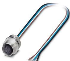
Connettore per apparecchi anteriore, Universale, 4-poli, Femmina, diritto, M12, codifica: A, su estremità conduttore libera, Montaggio anteriore, M16 x 1,5, Fili singoli, lunghezza cavo: 1 m, 0,34 mm<sup>2</sup>, Filo in TPE, saldato
