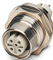
Connettore per apparecchi posteriore, 4-poli, Femmina, diritto, M12, codifica: A, Montaggio posteriore, Pg9, Saldatura a onde, connessione a vite per cavo Pg9, Questo articolo è in continuo adattamento. Alternativa senza piombo secondo RoHS II senza eccezione 6c (Pb < 0,1%) possibile in anticipo su richiesta.
