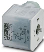
Connettore per valvole, Universale, 3-poli, Connettore per valvole A, Connessione a vite, connessione a vite per cavo Pg9, diametro esterno conduttore 6 mm ... 8 mm
