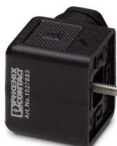
Connettore per valvole, Universale, 4-poli, Connettore per valvole A, Connessione a vite, connessione a vite per cavo Pg9, diametro esterno conduttore 6 mm ... 8 mm
