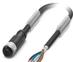
Cavo sensore/attuatore, 5-poli, PVC, nero RAL 9005, schermata (Advanced Shielding Technology), estremità conduttore libera, su Connettore femmina diritto M12, codifica: A, lunghezza cavo: 10 m
