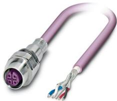
Connettore per apparecchi anteriore, CANopen®, DeviceNet™, 5-poli, PUR senza alogenati, lilla rossastro RAL 4001, schermata, Femmina, diritto, M12, codifica: A, su estremità conduttore libera, Montaggio anteriore, M16 x 1,5, Collegamento del cavo, lunghezza cavo: 2 m, CANopen®/DeviceNet™, PUR, viola, Prodotto alternativo secondo RoHS II senza eccezione 6c (Pb < 0,1 %) cod. art.: 1239895
