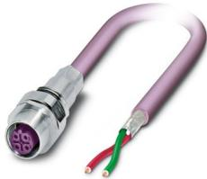
Connettore per apparecchi anteriore, 2-poli, PUR senza alogenati, lilla rossastro RAL 4001, schermata, Femmina, diritto, M12, codifica: B, su estremità conduttore libera, Montaggio anteriore, M16 x 1,5, Collegamento del cavo, lunghezza cavo: 5 m, 0,22 mm<sup>2</sup>, PROFIBUS, Questo articolo è in continuo adattamento. Alternativa senza piombo secondo RoHS II senza eccezione 6c (Pb < 0,1%) possibile in anticipo su richiesta.
