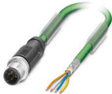
Cavo di rete, PROFINET CAT5 (100 MBit/s), EtherCAT® CAT5 (100 MBit/s), 4-poli, PVC/PVC, verde RAL 6018, schermata (Advanced Shielding Technology), Maschio diritto M12, codifica: D / IP67, su estremità conduttore libera, lunghezza cavo: 10 m
