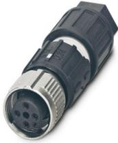
Connettore, Universale, 4-poli, Femmina diritto M12 SPEEDCON, codifica: A, Connessione a perforazione di isolante, materiale zigrinato: Pressogetto di zinco, nichelato, diametro esterno conduttore 3,5 mm ... 6 mm
