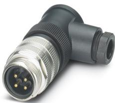
Connettore, Universale, 4-poli, Maschio angolato 7/8"-16UNF, codifica: A, Connessione a vite, materiale zigrinato: Pressogetto di zinco, nichelato, connessione a vite per cavo Pg9, diametro esterno conduttore 6 mm ... 8 mm, Contatto 4 anticipato
