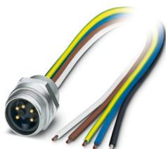
Connett. maschio da incasso sens./attuat., 5 poli, 7/8", montaggio anteriore con filett. Pg13,5, con filo PVC da 0,5 m, 5 x 0,75 mm<sup>2</sup>
