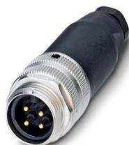
Connettore, Universale, 4-poli, Maschio diritto 7/8"-16UNF, codifica: A, Connessione a vite, materiale zigrinato: Pressogetto di zinco, nichelato, connessione a vite per cavo Pg9, diametro esterno conduttore 6 mm ... 8 mm, Contatto 4 anticipato
