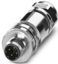
Connettore dati, Ethernet CAT5 (100 MBit/s), 4-poli, schermata, Maschio diritto M12, codifica: D, Connessione a vite, materiale zigrinato: Ottone, nichelato, connessione a vite per cavo Pg7, diametro esterno conduttore 4 mm ... 6 mm
