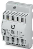
Modulo capacitivo STEP, con accumulo esente da manutenzione su condensatore a doppio strato, Montaggio su guida DIN, ingresso: 24 V DC, uscita: 24 V DC / 2 A / 0,4 kJ
