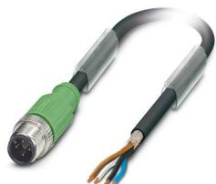
Cavo sensore/attuatore, 4-poli, PUR senza alogenati, grigio-nero RAL 7021, schermata (Advanced Shielding Technology), Maschio diritto M12, codifica: A, su estremità conduttore libera, lunghezza cavo: 15 m
