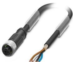
Cavo sensore/attuatore, 4-poli, PUR senza alogenati, grigio-nero RAL 7021, schermata (Advanced Shielding Technology), estremità conduttore libera, su Connettore femmina diritto M12, codifica: A, lunghezza cavo: 30 m
