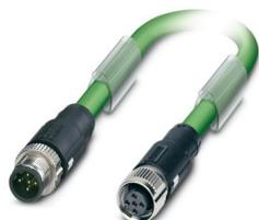
Cavo di sistema bus, INTERBUS (16 MBit/s), 5-poli, PUR senza alogenati, verde pallido RAL 6017, schermata, Maschio diritto M12 SPEEDCON, codifica: B, su Connettore femmina diritto M12 SPEEDCON, codifica: B, lunghezza cavo: 5 m
