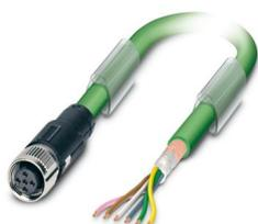
Cavo di sistema bus, INTERBUS (16 MBit/s), 5-poli, PUR senza alogenati, verde pallido RAL 6017, schermata, estremità conduttore libera, su Connettore femmina diritto M12 SPEEDCON, codifica: B, lunghezza cavo: 15 m
