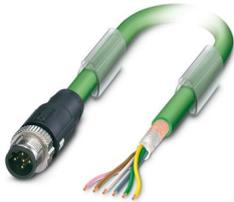
Cavo di sistema bus, INTERBUS (16 MBit/s), 5-poli, PUR senza alogenati, verde pallido RAL 6017, schermata, Maschio diritto M12 SPEEDCON, codifica: B, su estremità conduttore libera, lunghezza cavo: 10 m
