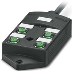
Scatola di distribuzione, applicazione: Standard, requisiti avanzati, tipo di connessione: Connettore femmina M12 Metallo, numero degli slot: 4, numero poli: 5, codifica: A, occupazione slot: doppi, segnalazione di stato: no, Universale; connessione linea principale: Attacco fisso 180°, PUR/PVC, lunghezza cavo: 5 m, schermatura: no
