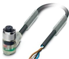
Cavo sensore/attuatore, 4-poli, PUR senza alogenati, grigio-nero RAL 7021, estremità conduttore libera, su Connettore femmina angolato M12, codifica: A, con 3 LED, lunghezza cavo: 10 m
