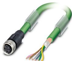
Cavo di sistema bus, INTERBUS (16 MBit/s), 5-poli, PUR senza alogenati, verde pallido RAL 6017, schermata, estremità conduttore libera, su Connettore femmina diritto M12, codifica: B, lunghezza cavo: 10 m
