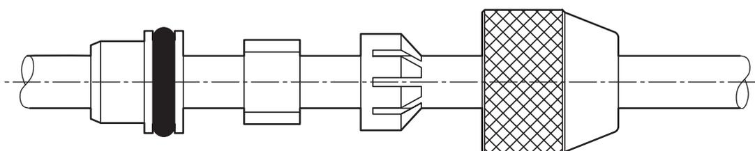
Sequenza di montaggio del connettore maschio/femmina M 8 e del conduttore
