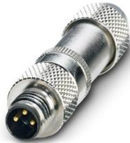
Connettore, Universale, 3-poli, schermata, Maschio diritto M8, codifica: A, Attacco a saldare, materiale zigrinato: Ottone, nichelato, diametro esterno conduttore 3,5 mm ... 5 mm
