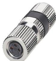
Connettore, Universale, 3-poli, Femmina diritto M8, codifica: A, Connessione rapida Piercecon®, materiale zigrinato: Ottone, nichelato, diametro esterno conduttore 3 mm ... 5 mm
