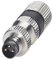
Connettore, Universale, 3-poli, Maschio diritto M8, codifica: A, Connessione rapida Piercecon®, materiale zigrinato: Ottone, nichelato, diametro esterno conduttore 3 mm ... 5 mm
