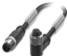
Cavo sensore/attuatore, 3-poli, PUR senza alogenati, grigio-nero RAL 7021, schermata (Advanced Shielding Technology), Maschio diritto M12, codifica: A, su Connettore femmina angolato M12, codifica: A, lunghezza cavo: 1,5 m
