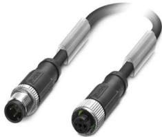
Cavo sensore/attuatore, 3-poli, PUR senza alogenati, grigio-nero RAL 7021, schermata (Advanced Shielding Technology), Maschio diritto M12, codifica: A, su Connettore femmina diritto M12, codifica: A, lunghezza cavo: 0,3 m
