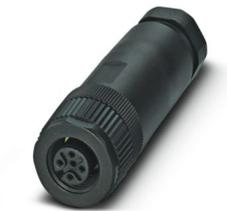
Connettore, Universale, 5-poli, Femmina diritto M12, codifica: A, Connessione a vite, materiale zigrinato: Plastica, connessione a vite per cavo Pg9, diametro esterno conduttore 6 mm ... 8 mm
