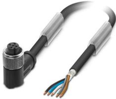
Cavo sensore/attuatore, 5-poli, PUR senza alogenati, grigio-nero RAL 7021, schermata (Advanced Shielding Technology), estremità conduttore libera, su Connettore femmina angolato M12, codifica: A, lunghezza cavo: 10 m
