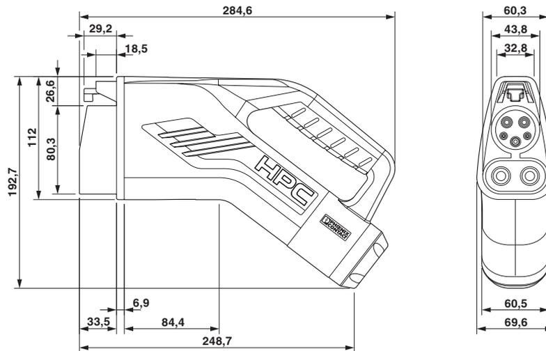
Assicurarsi che il connettore di ricarica lato veicolo sia inserito in un apposito supporto per il connettore di ricarica che garantisca una protezione di almeno IP24 secondo IEC 61851-1 durante l'intera pausa di ricarica. Per realizzare tale supporto, utilizzare le dimensioni del connettore di ricarica lato veicolo. Per informazioni più dettagliate sulle misure consultare l'area download.
