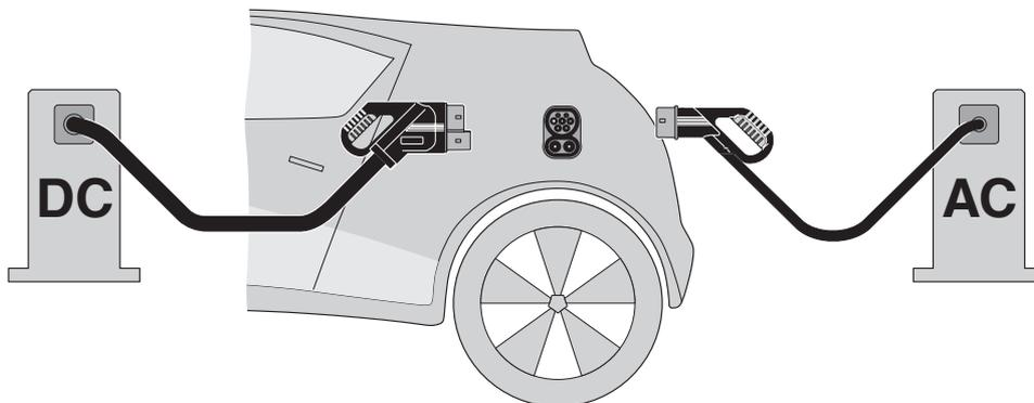
Principio del Combined Charging System (CCS) - sistema a inserzione a norma per ricarica per veicoli elettrici per la ricarica convenzionale con corrente alternata (AC) e la ricarica rapido con corrente continua (DC). Entrambe le spine di ricarica del veicolo sono adatte all'inlet veicolo CCS.
