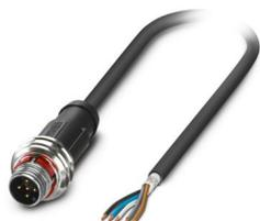
Cavo sensore/attuatore, 5-poli, PUR senza alogenati, grigio-nero RAL 7021, schermata (Advanced Shielding Technology), Maschio diritto M12 Push-Pull, codifica: A, su estremità conduttore libera, lunghezza cavo: 1,5 m
