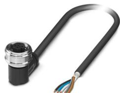
Cavo sensore/attuatore, 5-poli, PUR senza alogenati, grigio-nero RAL 7021, schermata (Advanced Shielding Technology), Connettore femmina angolato M12 Push-Pull, codifica: A, su estremità conduttore libera, lunghezza cavo: 10 m
