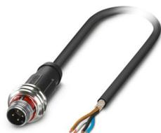
Cavo sensore/attuatore, 4-poli, PUR senza alogenati, grigio-nero RAL 7021, schermata (Advanced Shielding Technology), Maschio diritto M12 Push-Pull, codifica: A, su estremità conduttore libera, lunghezza cavo: 3 m
