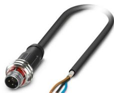
Cavo sensore/attuatore, 3-poli, PUR senza alogenati, grigio-nero RAL 7021, schermata (Advanced Shielding Technology), Maschio diritto M12 Push-Pull, codifica: A, su estremità conduttore libera, lunghezza cavo: 1,5 m
